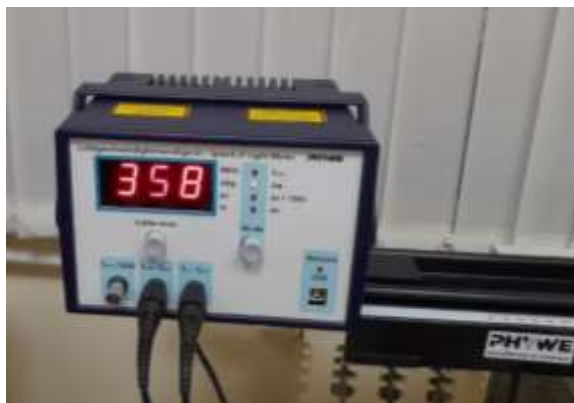
2-rasm. Retroreflektorli yorug'lik tezligini raqamli o'lchash qurilmasi.
